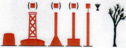
Backbordseite von See kommend Feuer (wenn vorhanden): Farbe rot
