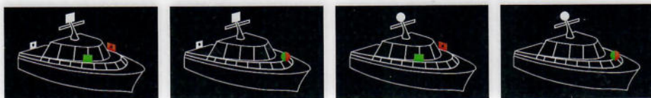
Maschinenfahrzeuge in Fahrt unter 12 m Länge
