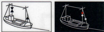
Treibnetzfisher mit mehr als 150 m ins Wasser reichendem, ausgebrachtem Fanggerät; Rechts: ohne Fahrt durchs Wasser
