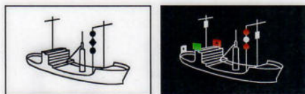
Manövrierbehindertes Fahrzeug mit Fahrt durchs Wasser über 50 m Länge
