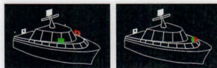
Maschinenfahrzeuge in Fahrt unter 20 m Länge
